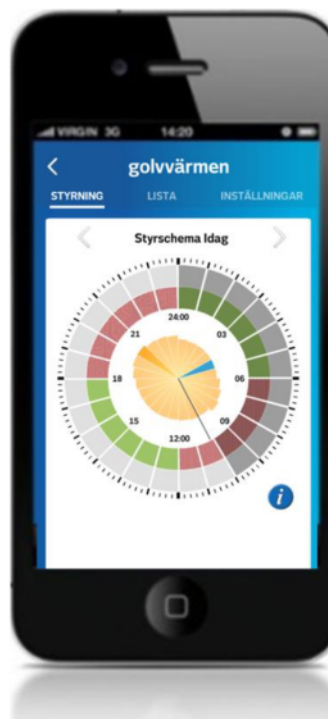
Figur 2: I Smart Grid Gotland utvecklades, och testades, teknisk utrustning för styrning av uppvärmning baserad på konsumtionsinformation i en Smartphone-applikation.
