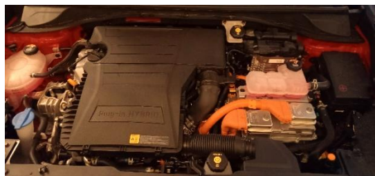
Motorutrymme med elmotor till vänster och förbränningsmotor till höger.
